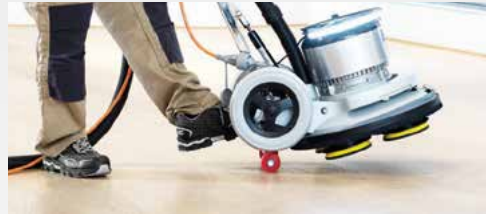
Zum wechseln von Schleifpapier oder zum wechseln des Schleiftellers wird der Stützfuss heruntergeklappt. Somit wird das Gewicht der Maschine auf den Stützfuss verteilt.
