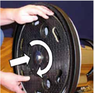
Montare il disco trascinatore Pad e svitare la vite centrale.
