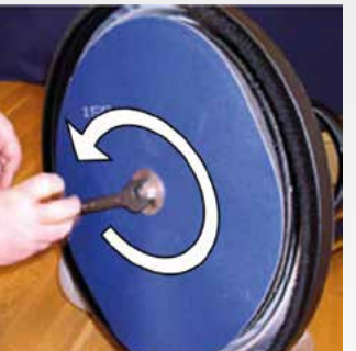
Insira e aperte o parafuso central.
