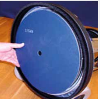
Posizionare il disco abrasivo.
