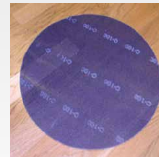
Das Schleifgitter auf den Boden legen.
