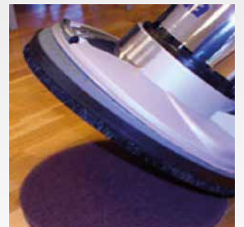
Die Maschine auf das Pad absenken.
