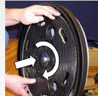
Bona Pad Drive montieren und mittlere Schraube lösen.
