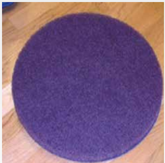
Coloque uma almofada de 16" sobre a lixa.
