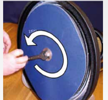
Die mittlere Schraube einsetzen und anziehen.
