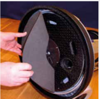
Instale a almofada de borracha.
