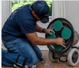
Montaggio di Bona Power Drive in senso orario.
