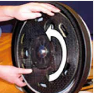
Montare il trascinatore Pad.
