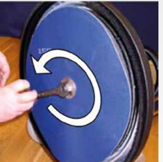
Inserire e serrare la vite centrale.
