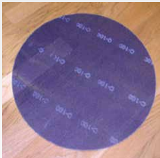
Posizionare la retina sul pavimento.
