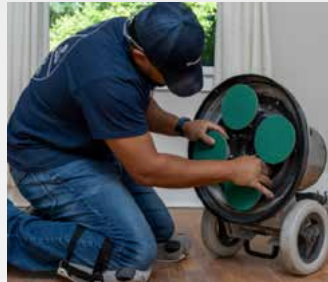
Befestigung des Bona Power Drive Schleiftellers
