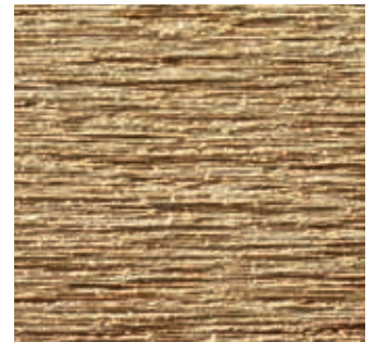
La superficie lijada con Abrasivos Bona es más suave y lisa, más uniforme y con fibras visiblemente menos dañadas.
